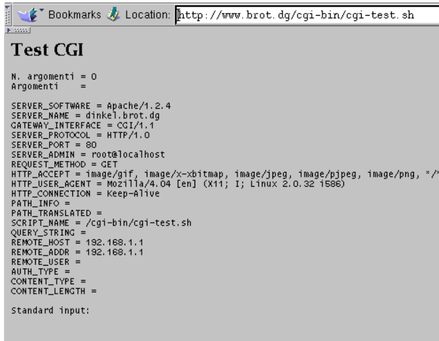
Figura 204.4. Richiamando lo script 'cgi-test.sh' attraverso un URI, senza l'indicazione di alcuna stringa di richiesta, si ottiene lo stato delle variabili di ambiente fornite allo script stesso.
